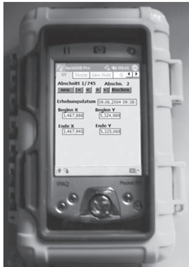
Abb. 1: Pocket PC in wasserdichter Box für die Erfassung der Eingangsdaten von MesoCASiMiR
